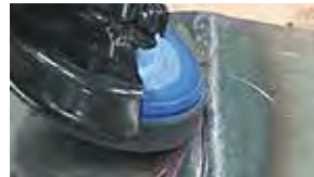
*Usuwanie niebieskich przebarwień spoin
